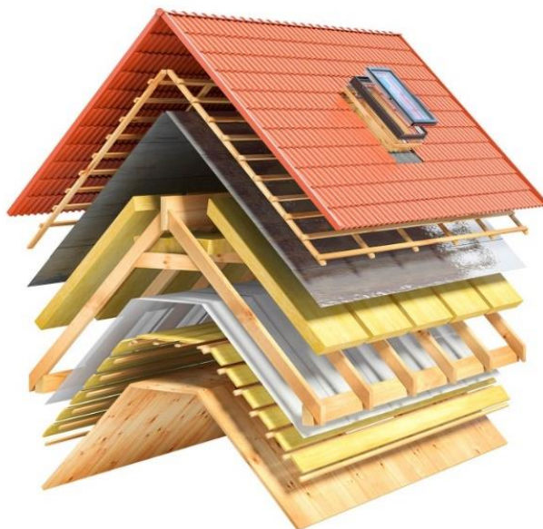
4. ábra. A tető hőszigetelése 4
