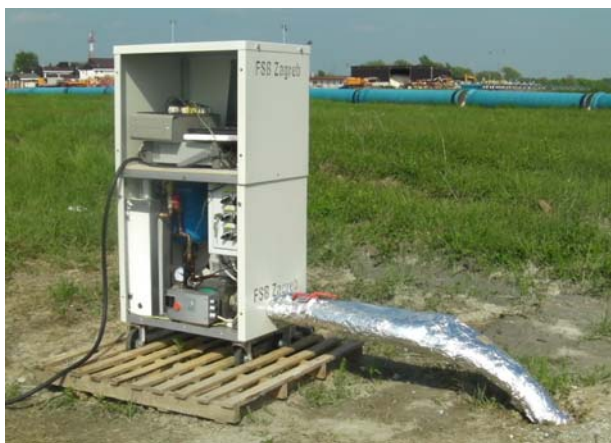
TRT test na lokaciji IKEA Rugvica
